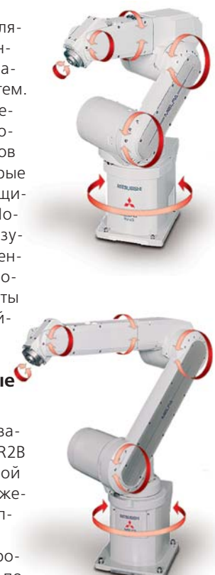
Степени свободы роботов RV-6S и RV-12SL
