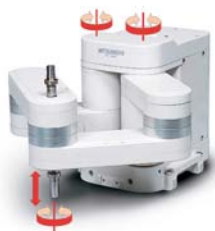
Степени свободы роботов RP-1AH, RP-3AH и RP-5AH
