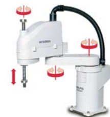
Степени свободы роботов RH-5AH RH-10AH
