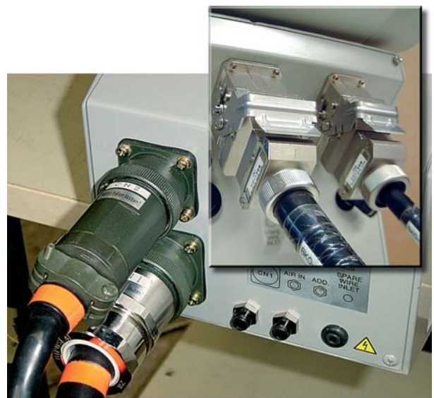
Сигнальное соединение, подача электропитания и сжатого воздуха к шарнирным роботам
