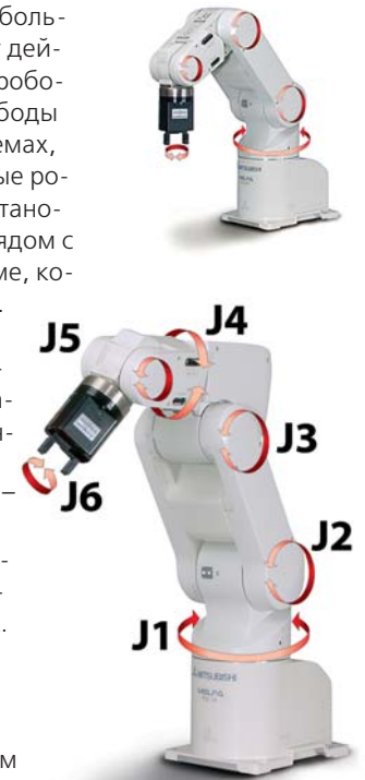
Степени свободы роботов RV-2AJ и RV-1A
